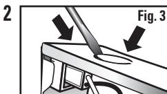
Una vez que usted haya determinado la posición en la que se montará el aplique de luz, marque el destapadero correspondiente más próximo al extremo multicable aislado y quítelo (Fig. 3). **QUITE CUIDOSAMENTE EL DESTAPADERO GOLPEÁNDOLO CON UN DESTORNILLADOR DE CABEZA PLANA O UN PUNZÓN HASTA QUE LA SUPERFICIE SE ROMPA.** Si el destapadero no se suelta, use unos alicates y doblelo hacia atrás y hacia delante hasta que se desprendra.
