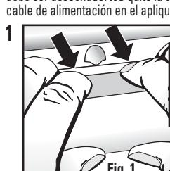
Ponga las puntas de los dedos sobre la lengüeta de fijación ubicada en el frente del compartimento de cables, presione sobre la cubierta y levántela (Fig. 1).
