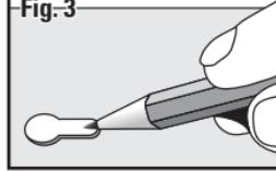
Placez le luminaire sur la surface de montage et marquez la position de l'extrémité étroite des trous en forme de serrure sur la surface de montage au moyen d'un crayon (**Fig. 3**). Les emplacements des trous de vis doivent être exacts pour que le luminaire puisse être installé correctement.
