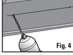
Au moyen d'une petite perceuse ou d'un clou, faites deux petits trous pilotes aux endroits indiqués (**Fig. 4**).
