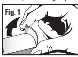
Quite la bombilla del aplique de luz colocando los pulgares sobre los extremos metálicos de la bombilla (**Fig. 1**). Cuando reemplace una bombilla defectuosa, utilice los pulgares para presionar la bombilla y hacerla rodar 90 grados en el interior del portalámpara. Esto desacoplará las espigas de contacto de la bombilla de los contactos del portalámpara. Luego, deslice las espigas de la bombilla hacia fuera, hasta sacarlas de la ranura del portalámpara.
