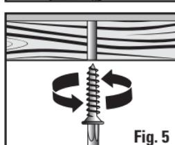
Enrosque los dos tornillos de montaje No. 8 hasta que quede aproximadamente 3,2 mm de espacio debajo de la cabeza del tornillo (**Fig. 5**).
