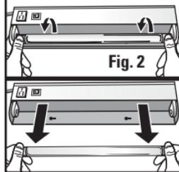
Retirez l'ampoule du luminaire en plaçant vos pouces sur les extrémités en métal de l'ampoule. Tout en faisant légèrement pression sur l'ampoule, roulez l'ampoule vers vous jusqu'à ce que les chevilles de contact aux extrémités de l'ampoule se dégagent de la douille (**Fig. 2**). Tirez l'ampoule tout droit pour la faire sortir de la douille et mettez-la de côté pendant le montage.
