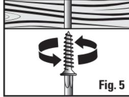
Vissez les deux vis de montage N° 8 jusqu'à ce qu'il reste approximativement 3 mm d'espace sous la tête de la vis (**Fig. 5**).
