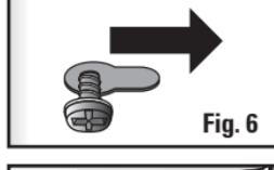
Faites glisser le luminaire jusqu'à ce que les pieds étroits des fentes en forme de trou de serrure soient au-dessous des têtes des vis (**Fig. 6**). Finissez de serrer les vis jusqu'à ce qu'elles soient fermement à leur place et que le luminaire soit assujetti solidement à la surface de montage.
