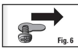
Deslice el aplique de luz hasta su posición, de manera que las patas estrechas de las ranuras de bocallave estén debajo de las cabezas de los tornillos (**Fig. 6**). Acabe de apretar los tornillos hasta que estén firmemente asentados y el aplique de luz esté firmemente sujetado a la superficie de montaje.
