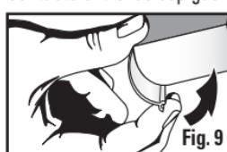
Coloque el difusor en el reborde superior. Empuje el borde ranurado hacia abajo, hacia el interior del borde inferior, hasta que quede bloqueado (**Fig. 9**).
