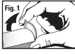
Retirez le diffuseur en tirant vers l'arrière et vers le haut sur le bord supérieur du diffuseur avec le bout de vos doigts (**Fig. 1**). Lorsque vous remplacez une ampoule défectueuse, utilisez vos pouces pour appuyer sur l'ampoule et la faire tourner de 90° à l'intérieur de la douille. Ceci désengagera les chevilles de contact de l'ampoule des contacts de la douille. Puis faites glisser les chevilles de l'ampoule en dehors de l'encoche de la douille.
