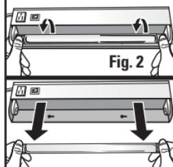
Quite la bombilla del aplique de luz, colocando los pulgares sobre los extremos metálicos de la bombilla. Mientras ejerce una presión ligera sobre la bombilla, haga rodar la bombilla hacia usted, hasta que las espigas de contacto ubicadas en los extremos de la bombilla se desacoplen del portalámpara. Tire de la bombilla directamente hacia fuera del portalámpara y póngala a un lado durante el montaje (**Fig. 2**).
