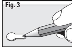
Coloque el aplique de luz en alto contra la superficie de montaje y, utilizando un lápiz, marque la posición del extremo estrecho de los agujeros de ranura de bocallave en la superficie de montaje (**Fig. 3**). Las ubicaciones de los agujeros para tornillo deben ser exactas para que el aplique de luz se monte correctamente.
