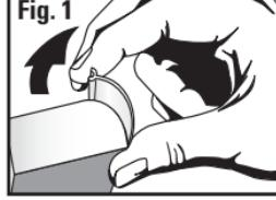
Retirez le diffuseur en tirant vers l'arrière et vers le haut sur le bord supérieur du diffuseur avec le bout de vos doigts (**Fig. 1**).
