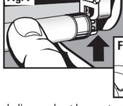
Installez l'ampoule dans les douilles en alignant les chevilles de fixation de l'ampoule dans les fentes des prises (**Fig. 7**). En vous servant du pouce et de l'index de chaque main, appuyez sur les bouts en métal de la douille de l'ampoule et faites rouler l'ampoule vers l'avant jusqu'à ce qu'elle ait tourné de 90 degrés à l'intérieur de la douille et établi un contact entre les chevilles de fixation de l'ampoule et les contacts des douilles (**Fig. 8**).
