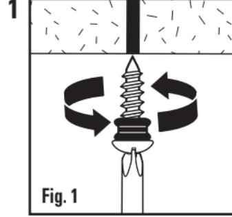
Use un clavo o taladro pequeño para hacer dos orificios guía pequeños en las ubicaciones marcadas. Coloque una arandela sobre cada tornillo para madera. Atornille los dos tornillos para madera hasta que las arandelas entren en contacto con la parte inferior de la superficie de montaje. Luego gire los tornillos un cuarto de giro adicional (Fig. 1). Los tornillos deben ingresar de forma recta para que la lámpara se instale de forma adecuada.
