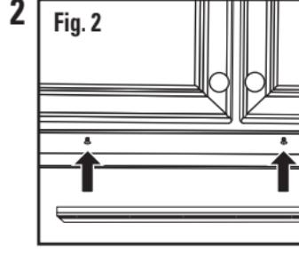
Coloque la lámpara sobre la cabeza de los tornillos para madera (Fig. 2). Deslice la lámpara por encima de forma tal que la cabeza de los tornillos para madera entren en la sección delgada de las ranuras en forma de cerrojo. Si la lámpara sigue floja, retírela y apriete los tornillos para madera un cuarto de vuelta más. Una vez que el accesorio para iluminación esté montado de manera segura, inserte el cable de alimentación en dicho accesorio y luego enchúfelo en el tomacorriente de la pared.
