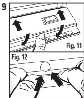
Fixez de nouveau le couvercle du compartiment des fils en rattachant le couvercle au boîtier du luminaire et en le fermant (Fig. 11). Appuyez sur le couvercle et fixez le rebord avant sous la languette de verrouillage (Fig. 12).
