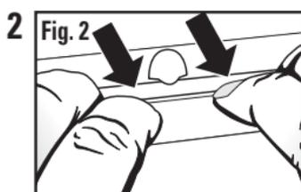
Pour ouvrir le couvercle du compartiment des fils, dégagez les deux languettes de verrouillage du boîtier en enfonçant le côté du couvercle du compartiment des fils (Fig. 2) et en le soulevant de façon à exposer les connexions et la trousse de quincaillerie qui se trouvent à l'intérieur (Fig. 3).
