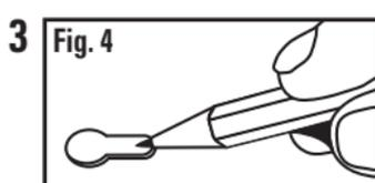
Marquez la zone générale dans laquelle vous voulez installer le luminaire. Repérez les encoches de montage en trou de serrure au dos du luminaire. Marquez l'endroit correspondant sur la surface de montage (Fig. 4).
