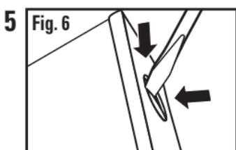
Determine qué destapadero correspondiente está más cerca de la línea del cable de alimentación y retírelo. **RETIRE CADA ORIFICIO SEMIPERFORADO GOLPEÁNDOLO CON UN DESTORNILLADOR DE CABEZA PLANA O PUNZÓN HASTA QUE SE ABRA (Fig. 6)**. Si no se puede perforar el orificio, utilice pinzas y dóblelo hacia delante y hacia atrás hasta que salga.
