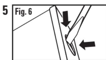
Déterminez quelle section défonçable correspondante est la plus proche du fil d'alimentation et retirez-la. **RETIREZ SOIGNEUSEMENT LA PASTILLE DÉFONÇABLE EN APPUYANT UN TOURNEVIS À TÊTE PLATE OU UN POINÇON SUR LA PASTILLE ET EN LE FRAPPANT À L'AIDÉ D'UN MARTEAU JUSQU'À CE**
