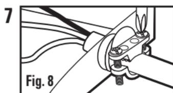
Insérez le câble NM ou le déviateur flexible (non incluses) à travers le coupleur de fils et serrez la bride jusqu'à ce que l'ensemble soit bien assujetti (Fig. 8). Laissez suffisamment de longueur de fil pour permettre de réaliser la connexion. **AVERTISSEMENT :** assurez-vous que le luminaire est HORS TENSION.
