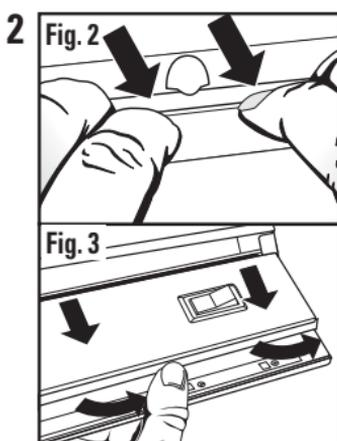
Para abrir la cubierta del compartimiento de cables, desenganche ambas pestañas de cierre del chasis presionándolas en el costado de la cubierta del compartimiento de cables (Fig. 2) y levantándolas para exponer las conexiones de cables y el kit de aditamentos en el interior (Fig. 3).
