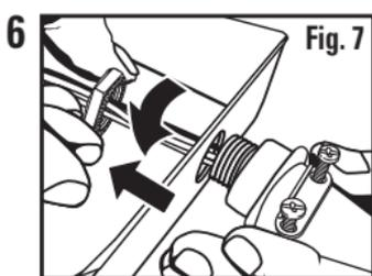
Instale el protector antijalones insertando el extremo roscado a través del destapadero (**Fig. 7**). Sujete firmemente el protector antijalones al accesorio para iluminación apretando el sujetador en el tubo roscado. **NOTA:** Recuerde tener los tornillos del protector antijalones orientados de manera que se permita tanto apretar como aflojar la abrazadera después de haber instalado el accesorio para iluminación en la superficie de montaje.
