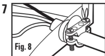
Inserte la conexión flexible o el cable NM (no se incluyen) a través del acoplamiento de cable y apriete la abrazadera hasta que se sujete firmemente (**Fig. 8**). Deje suficiente longitud de cable para hacer la conexión. **ADVERTENCIA:** Asegúrese de que el SUMINISTRO ELÉCTRICO esté APAGADO.
