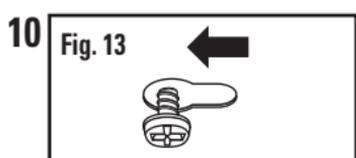
Faites glisser le luminaire par dessus la surface de montage jusqu'à ce que les extrémités étroites des fentes en forme de trou de serrure soient sous les têtes des vis à bois (Fig. 13). Achevez de serrer les vis à bois jusqu'à ce qu'elles soient fermement en place et que le luminaire soit fermement assujéti à la surface de montage.
