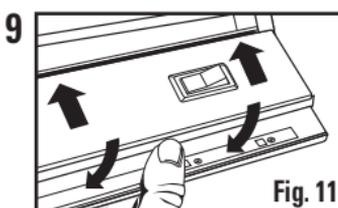
Vuelva a conectar la cubierta del compartimento de cables asegurando la cubierta con el chasis de la lámpara y cerrando (**Fig. 11**). Presione la cubierta y fije el borde frontal bajo la pestaña de cierre. (**Fig. 12**).
