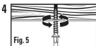
Utilisez un poinçon ou un clou pour emboutir les trous de vis ou percez un trou pilote aux endroits marqués dans ce but. Serrez les vis en laissant dépasser de la surface 1/2 po (1,25 cm) de la vis (Fig. 5).
