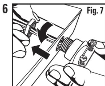
Attachez le serre-fil réducteur de tension en insérant l'extrémité fileté à travers la section défoncée (Fig. 7). Assujettissez le serre-fil réducteur de tension sur le luminaire en serrant l'attache sur le tube fileté.
