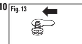
Deslice el accesorio para iluminación por encima hasta que los extremos estrechos de las ranuras de bocallave estén debajo de las cabezas de los tornillos para madera (**Fig. 13**). Acabe de apretar los tornillos para madera hasta que estén firmemente asentados y el accesorio para iluminación esté sujeto de manera segura a la superficie de montaje.
