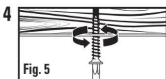
Utilice un punzón o un clavo para comenzar a hacer la hendidura de los agujeros para tornillo o taladre un agujero piloto de 1/16 de pulgada en las ubicaciones marcadas. Apriete los tornillos dejando que sobresalgan 1/2 pulgada de la superficie (**Fig. 5**).
