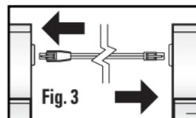
Conecte otras lámparas siguiendo las instrucciones de conexión descritas en los pasos 1 y 2 (Fig. 3). Una vez que se conectaron todas las lámparas, introduzca el enchufe del conector del cable de alimentación en el puerto de alimentación que está en el extremo de la última lámpara y el enchufe de conexión a tierra en el tomacorriente. **NOTA:**
