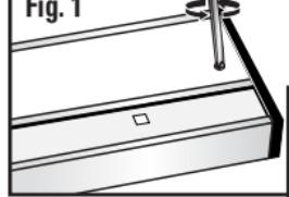
Le luminaire est muni de vis de montage imperméables préinstallées à l'intérieur du compartiment des fils. Pour repérer ces vis de montage, retirez d'abord les vis des deux côtés du
