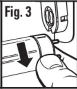
Retire la bombilla de la lámpara, colocando ambos pulgares en los extremos metálicos de la bombilla (Fig. 2). Mientras ejerce una presión leve en los extremos metálicos, gire la bombilla hacia delante hasta que las clavijas de contacto que están en los extremos de la bombilla se desconecten del portalámpara (Fig. 3). Quite la bombilla del portalámpara jalándola de forma recta y colóquela aparte.
