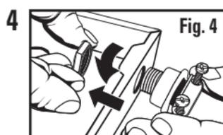
4 Fije el aliviador de tensión introduciendo el extremo roscado por el orificio (Fig. 4). Asegure el aliviador de tensión a la lámpara ajustando el sujetador al tubo roscado. **NOTA:** Recuerde orientar los tornillos del aliviador de tensión de forma tal que permitan apretar o aflojar la abrazadera después de haber fijado la lámpara a la superficie de montaje.
