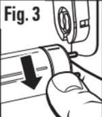
Retire la bombilla de la lámpara, colocando ambos pulgares en los extremos metálicos de la bombilla (Fig. 2). Mientras ejerce una presión leve en los extremos metálicos, gire la bombilla hacia delante hasta que las clavijas de contacto que están en los extremos de la bombilla se desconecten del portalámpara (Fig. 3).
