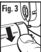
Pour retirer l'ampoule du luminaire, placez vos deux pouces sur ses embouts métalliques (fig. 2). Appliquez une légère pression sur les embouts métalliques, puis tournez l'ampoule vers l'avant jusqu'à ce que les broches de contact des embouts sortent des douilles (fig. 3). Retirez l'ampoule des douilles en la tenant bien droite, puis mettez-la de côté.
