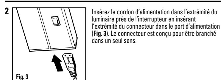
Insérez le cordon d'alimentation dans l'extrémité du luminaire près de l'interrupteur en insérant l'extrémité du connecteur dans le port d'alimentation (Fig. 3). Le connecteur est conçu pour être branché dans un seul sens.
