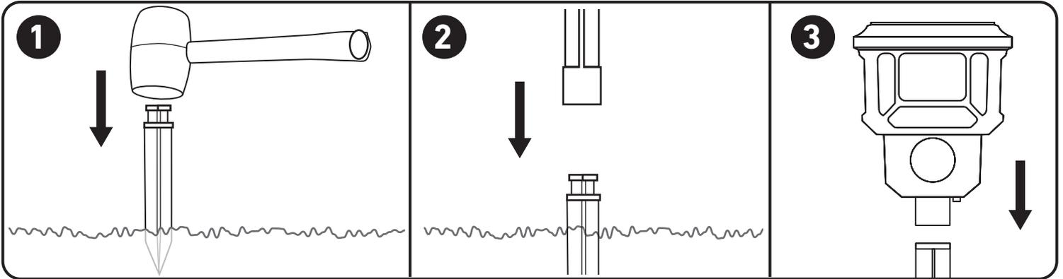
Pour monter la lampe avec le piquet inclus, utilisez un maillet pour insérer le piquet dans le sol. N'utilisez **PAS** un marteau.
