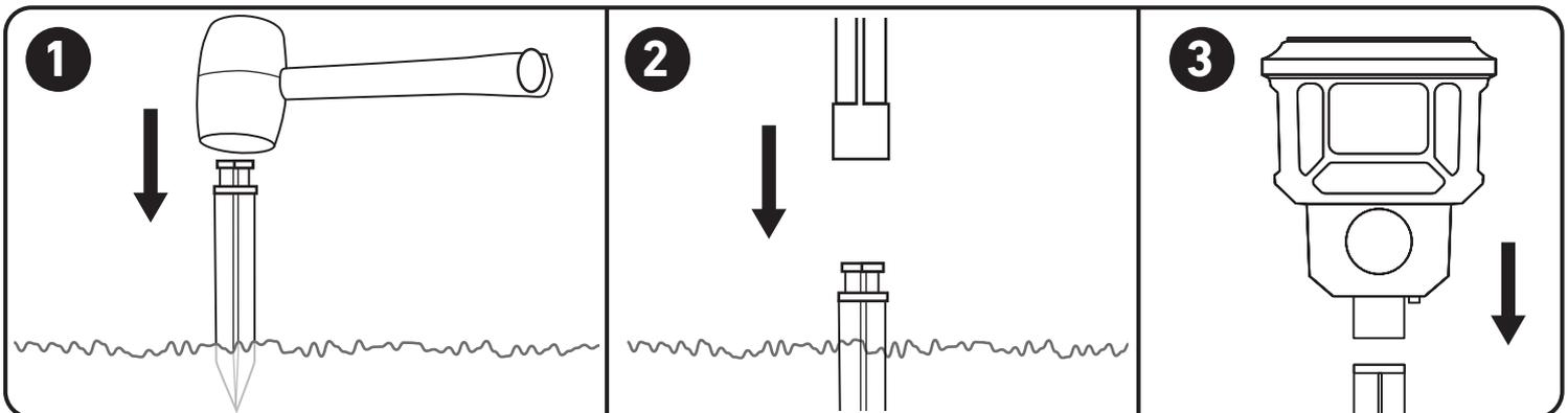
Para montar la luz con la estaca incluida, utilice un mazo para insertar la estaca en el terreno. No UTILICE un martillo.
