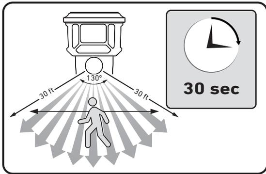
La luz se activa cuando el sensor de movimiento detecta movimiento. El sensor detecta movimiento en una zona de cobertura de 130° hasta 30 pies. El sensor tiene la máxima eficacia para detectar movimiento de un lado a otro, en lugar de movimiento que viene directamente hacia él (hacia dentro y hacia fuera). El "tiempo encendida" de la luz es de 30 segundos después de cada vez que se detecte movimiento durante horas nocturnas.
