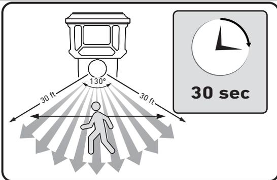
La lumière s'allume lorsque le détecteur de mouvement détecte un mouvement. Le détecteur détecte les mouvements dans une zone de couverture de 130° jusqu'à 30 pi. Le détecteur est plus efficace en cas de mouvement latéral, d'un côté à l'autre, que si le mouvement avance tout droit vers le détecteur (aller-retour). Le « temps d'allumage » de la lumière est de 30 secondes après chaque détection de mouvement pendant la nuit.
