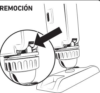
Pour retirer le luminaire, déverrouillez la barre de la base de montage et appuyez sur la languette de déverrouillage située au bas du luminaire. Tout en continuant à appuyer, faites glisser le luminaire vers l'extérieur.
