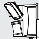
**EL ACCESORIO PARA ILUMINACIÓN UTILIZA UN SENSOR DE MOVIMIENTO INFRARROJO PASIVO (PIR) Y COMO TAL DETECTA LOS CAMBIOS EN RADIACIÓN INFRARROJA DE OBJETOS CALIENTES QUE SE MUEVEN A TRAVÉS DE LAS ZONAS DE DETECCIÓN.**
