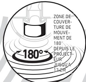
**LE LUMINAIRE UTILISE UN CAPTEUR DE MOUVEMENT À RAYONS INFRAROUGES PASSIF (PIR) ET DÉTECTE AINSI LES CHANGEMENTS DANS LE RAYONNEMENT INFRAROUGE DES OBJETS CHAUDS SE DÉPLACANT DANS LES ZONES DE DÉTECTION.**
