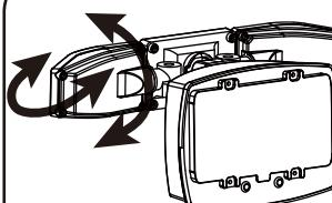
Las cabezas de luz individuales se pueden ajustar hacia arriba y hacia abajo y hacia la izquierda y hacia la derecha para dirigirlas en el sentido deseado.
