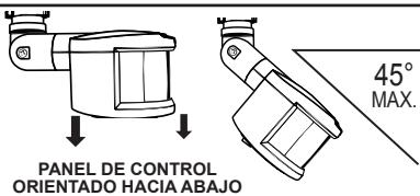
Ajuste el panel de control del PIR en la ubicación deseada.
