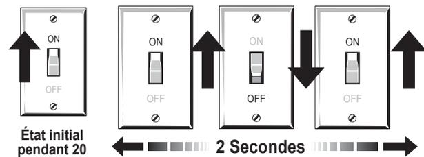
État initial pendant 20 secondes pour laisser au détecteur le temps de chauffer
