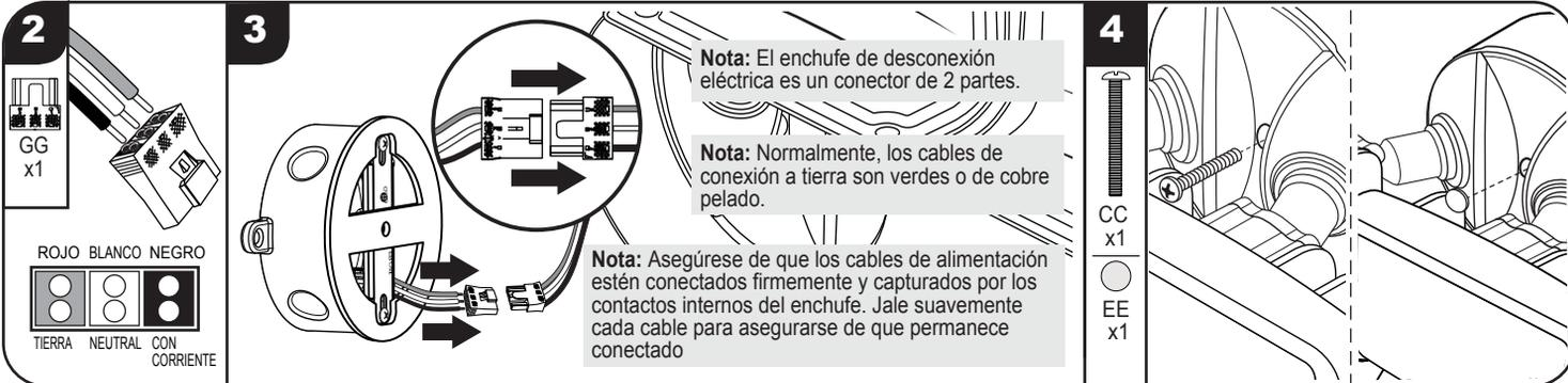
**2** Empuje los extremos de los cables de la casa procedentes de la caja de conexiones hacia el interior de los agujeros de contacto del enchufe de desconexión eléctrica del kit de herrajes (GG) y empareje cuidadosamente el color de los cables blanco y negro correspondientes a la superficie codificada por colores del conector. Inserte el cable de conexión a tierra de la casa en el agujero marcado por la superficie roja. Verifique que los cables están firmemente sujetos.
