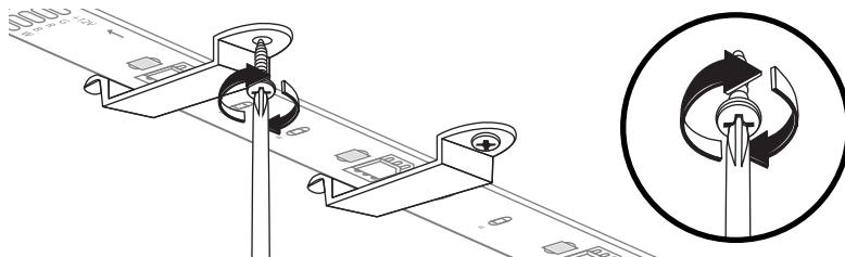
Tenez le ruban lumineux à l'endroit désiré. Placez délicatement les pinces de fixation sur le ruban lumineux et vissez dans la surface en faisant attention de ne pas enfoncez une vis dans le ruban lumineux.
