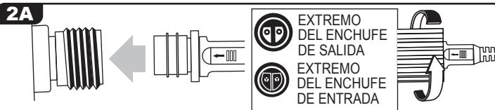
El enchufe y el cable tienen dos extremos distintos: una entrada y una salida. Alinee la flecha e inserte el **EXTREMO DEL ENCHUFE DE SALIDA** en el **CONECTOR DE SALIDA** del accesorio para iluminación precedente e inserte el **EXTREMO DEL ENCHUFE DE ENTRADA** en el **CONECTOR DE ENTRADA** del accesorio para iluminación que se está añadiendo. Gire la pieza de conexión estanca al agua hasta que esté completamente apretada.
