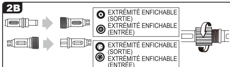
La fiche et le cordon ont deux extrémités différentes: une entrée et une sortie avec alignement vers le haut de la flèche, et insérez **L'EXTRÉMITÉ DE LA FICHE DE SORTIE** dans le **CONNECTEUR DE SORTIE** du luminaire précédent, puis insérez **L'EXTRÉMITÉ DE LA FICHE D'ENTRÉE** dans le **CONNECTEUR D'ENTRÉE** du luminaire ajouté. Tournez la pièce de connexion pour couper l'eau jusqu'à ce qu'elle soit complètement serrée.
