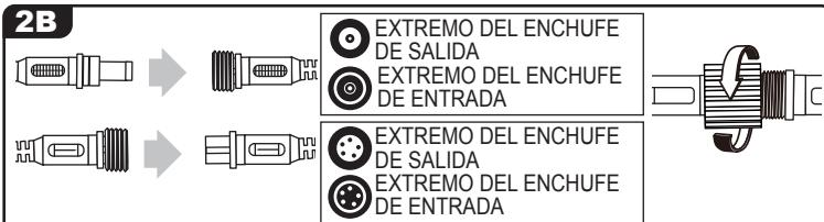
Los dos cables distintos tienen dos extremos distintos: una entrada y una salida. Inserte el **EXTREMO DEL ENCHUFE DE SALIDA** en el **CONECTOR DE SALIDA** del accesorio para iluminación precedente e inserte el **EXTREMO DEL ENCHUFE DE ENTRADA** en el **CONECTOR DE ENTRADA** del accesorio para iluminación que se está añadiendo. Gire la pieza de conexión estanca al agua hasta que esté completamente apretada.
