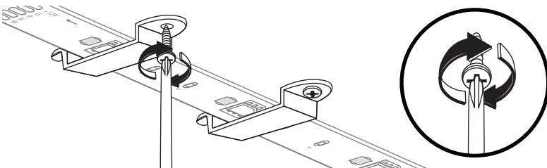
Sostenga la franja luminosa en la ubicación deseada. Coloque cuidadosamente los clips de montaje sobre la franja luminosa y atorníllelos en la superficie, teniendo cuidado de no atornillarlos en la franja luminosa.
