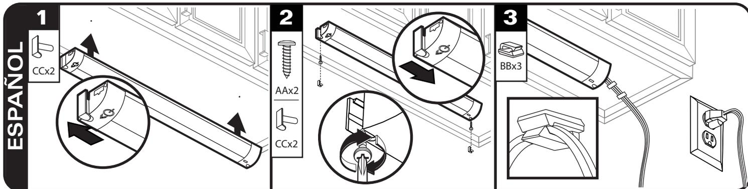
1. Retire las cubiertas de tornillo (CC) en ambos extremos. Marque el área general en la que se montará el accesorio para iluminación. Utilizando una broca pequeña o un clavo pequeño, haga dos agujeros piloto pequeños en las ubicaciones marcadas. **NOTA:** Asegúrese de que la ubicación de montaje esté a 1,5 m o menos de un tomacorriente.
