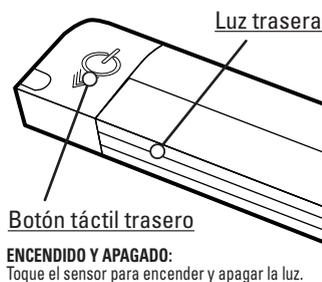
**ENCENDIDO Y APAGADO:** Toque el sensor para encender y apagar la luz.
