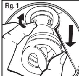
Retirez l'ampoule à remplacer en la saisissant fermement par son culot en plastique et faites tourner fermement l'ampoule dans le sens contraire des aiguilles d'une montre jusqu'à ce qu'elle ne soit plus assujettie et qu'elle s'aligne avec la grande extrémité des ouvertures (**Fig. 1**). Tirez tout droit vers le haut. Faites attention de ne pas laisser tomber l'ampoule.
