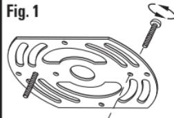
Vissez les vis de mécanique longues (incluses) dans les trous filetés sur le support de montage (Fig. 1). Si votre support de montage comporte plus de deux trous filetés, mesurez la distance d'un centre à l'autre des trous pour vous assurer qu'elle correspond aux ouvertures des trous du panneau de fixation de votre luminaire.
