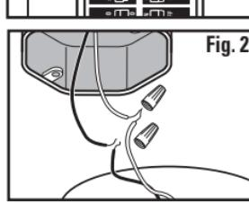
Quite la lámpara vieja. Hágase un boceto de cómo está cableada la lámpara (indique en el boceto el color de los cables) o marque los cables mismos con cinta adhesiva de pintor y un lápiz para que recuerde cómo conectar los cables a su nueva lámpara (**Fig. 2**). Si hay varios cables involucrados o si el cableado parece más complicado y quizás incluye un cable rojo, anote las conexiones antes de desconectarlas.
