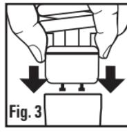
Saisissez l'ampoule de remplacement de la même manière. Insérez l'ampoule de remplacement dans la douille et faites tourner l'ampoule dans le sens des aiguilles d'une montre jusqu'à ce qu'elle repose fermement à sa place (**Fig. 2 et Fig. 3**). Ne forcez pas l'ampoule dans la douille et ne serrez pas trop fort.
