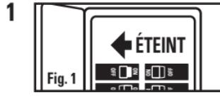
**AVERTISSEMENT:** coupez l'alimentation électrique au niveau du disjoncteur ou du panneau de fusibles avant de retirer l'ancien luminaire (**Fig. 1**).
