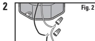
Retirez l'ancien luminaire. Faites un croquis du schéma de câblage du luminaire (en utilisant des couleurs différentes, ou des codes de couleur, pour chaque fil), ou marquez les fils eux-mêmes avec un ruban adhésif et un crayon pour que vous sachiez comment connecter les fils de votre nouveau luminaire (**Fig. 2**). Cependant, si plusieurs fils sont impliqués, ou si le câblage semble plus compliqué et inclut même un fil rouge, prenez note des connexions avant d'effectuer la déconnexion.
