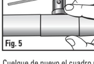
Utilizando la llave Allen incluida, apriete el tornillo de ajuste en la junta giratoria para impedir que la cabeza gire, una vez que la cabeza de la luz esté en la posición que a usted le parezca mejor (**Fig. 5**).
