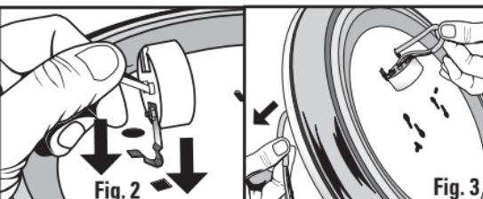
Pour installer la douille de l'ampoule, poussez le clip de la douille en métal à l'intérieur du trou rectangulaire jusqu'à ce que vous entendiez un déclic (Fig. 2). Faites passer les fils de la douille de l'ampoule à travers le trou de fil circulaire, tirez-les autant que vous le pouvez depuis l'autre côté sans les tendre excessivement (Fig. 3).
