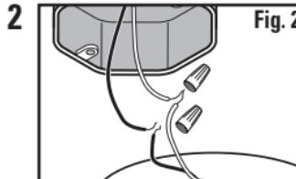
Quite la lámpara vieja. Hágase un boceto de cómo está cableada la lámpara (indique en el boceto el color de los cables) o marque los cables mismos con cinta adhesiva de pintor y un lápiz para que recuerde cómo conectar los cables a su nueva lámpara (Fig. 2). Si hay varios cables involucrados o si el cableado parece más complicado y quizás incluye un cable rojo, anote las conexiones antes de desconectarlas.
