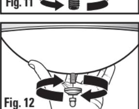
Coloque el difusor sobre el tubo central roscado y mientras sostiene en posición el difusor con una mano, coloque la tapa del difusor sobre el vástago roscado y sujetela firmemente la tapa y el difusor con el remate roscado (Fig. 12).
