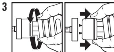
Retirez l'ampoule à remplacer en la saisissant fermement par son culot en plastique et faites tourner fermement l'ampoule dans le sens contraire des aiguilles d'une montre jusqu'à ce qu'elle ne soit plus assujettie et qu'elle s'aligne avec la grande extrémité des ouvertures (Fig. 2). Tirez tout droit. Faites attention de ne pas laisser tomber l'ampoule.
