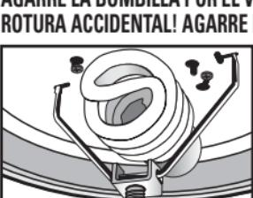
Enrosque en el harpa el tubo roscado incluido, de la manera que se muestra en la ilustración (Fig. 11).
