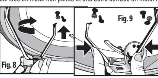
Une lyre est incluse dans votre kit de visserie de montage. Il existe des rainures de chaque côté de la lyre. Alignez un côté de la lyre avec l'ovale allongé du panneau de fixation de votre luminaire et insérez-la jusqu'à ce qu'elle entre en contact avec la rainure (Fig. 8). Faites-la tourner de façon qu'elle soit face à la fente en forme de T, puis comprimez jusqu'à ce que la lyre tienne dans la rainure (Fig. 9).
