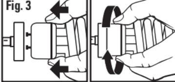
Agarre la bombilla de repuesto de la misma manera. Inserte la bombilla de repuesto en el portalámpara y gire la bombilla en el sentido de las agujas del reloj hasta que se "asiente" (Fig. 3). No fuerce la bombilla hacia el interior del portalámpara ni la enrosque con una fuerza excesiva.
