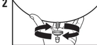
Tout en maintenant le diffuseur en place, dévissez le capuchon décoratif en faisant attention de ne pas laisser tomber le diffuseur (Fig. 1). Retirez l'embout du diffuseur et le diffuseur lui-même.
