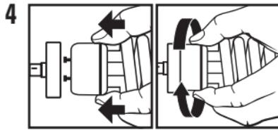
Saisissez l'ampoule de remplacement de la même manière. Insérez l'ampoule de remplacement dans la douille et faites tourner l'ampoule dans le sens des aiguilles d'une montre jusqu'à ce qu'elle repose fermement à sa place (Fig. 3). Ne forcez pas l'ampoule dans la douille et ne serrez pas trop fort.
