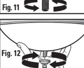
Placez le diffuseur au-dessus du tube central fileté et, tout en tenant d'une main le diffuseur en place, placez l'embout du diffuseur sur la tige filetée, et assujettissez à la fois le diffuseur et l'embout du diffuseur au moyen du capuchon décoratif fileté (Fig. 12).
