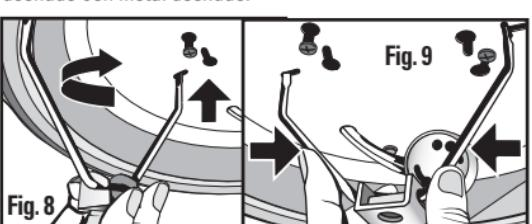
En el juego de herrajería se incluye un harpa. Hay ranuras a cada lado del harpa. Alinee un lado del harpa con el óvalo alargado de la bandeja del accesorio para iluminación e inserte el harpa hasta que llegue a la ranura (Fig. 8). Gire el harpa de manera que quede orientada hacia la ranura con forma de T y luego comprima el harpa hasta que encaje en la ranura (Fig. 9). Suelte el harpa para que quede fija en la posición deseada.
