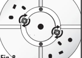
Retirez la pellicule de cellophane de l'abat-jour. Positionnez l'abat-jour au-dessus des vis qui dépassent du luminaire. Serrez en place en utilisant les écrous hexagonaux décoratifs joints (Fig. 8).
