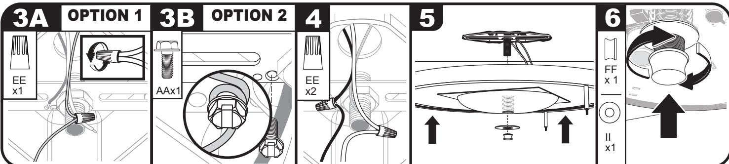
**3A Option 1:** Si la boîte de jonction est munie d'un fil de mise à la terre, connectez le fil de mise à la terre du luminaire au fil de mise à la terre de la boîte de jonction électrique en utilisant un serre-fils (**EE**). Les fils de mise à la terre sont normalement verts ou couleur de cuivre nu.
