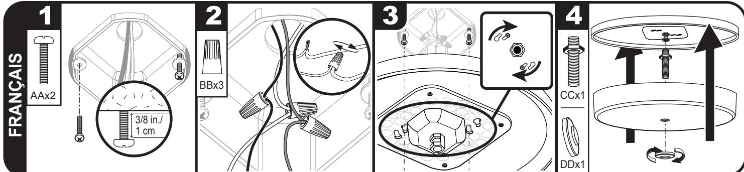
**1** Utilisez soit les vis existantes du coffret électrique, soit celles qui sont incluses dans le kit de petit matériel de fixation (AA). Vissez les vis à métaux (AA) dans le coffret électrique jusqu'à ce qu'il y ait environ 3/8 in./ 1 cm entre le plafond et le dessous des têtes des vis.
