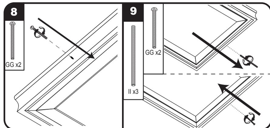
**8** Insérez les vis machine longues (GG) à travers l'un des deux trous pré-percés à chaque extrémité du cadre, et fixez-les dans le trou fileté du panneau plat à DEL.
