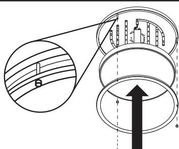
**4** Positionnez le diffuseur et l'anneau décoratif contre le support du luminaire. Une fois que les trous sont alignés, maintenez en place le diffuseur et l'anneau et fixez les capuchons de montant à l'anneau décoratif. Rétablissez l'alimentation électrique.
