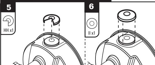
**5** El accesorio para iluminación viene con un sensor de anochecer a amanecer incorporado. Si la luz de seguridad cicla entre ENCENDIDO y APAGADO, es posible que el sensor de anochecer a amanecer se esté activando debido a luz reflejada por una superficie cercana. Coloque la tapa del sensor direccional (HH) firmemente sobre el sensor de anochecer a amanecer. Esto debería evitar que la luz extraña active el sensor de anochecer a amanecer.
