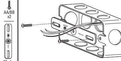
**1E** Jale los cables de suministro hacia fuera de la caja de conexiones (caja C). Con el lado marcado con la palabra "FRONT" (FRENTE) orientado hacia fuera, fije la correa de montaje (FF) a la caja C con tornillos para metales (AA o BB).
