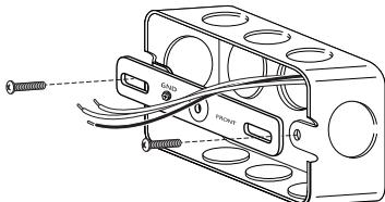
**1E** Tirez sur les fils d'alimentation pour les faire sortir de la boîte de jonction (j-box). Positionnez le côté marqué « FRONT » (Avant) vers l'extérieur et attachez la sangle de montage (FF) à la boîte de jonction (j-box) à l'aide des vis à métaux (AA ou BB).
