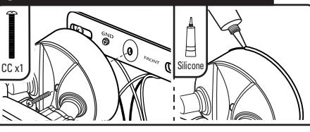
**3** Alinee los agujeros centrales del accesorio para iluminación y la correa de montaje (fijada a la caja C). Inserte el tornillo para metales largo (CC) a través del agujero central del accesorio para iluminación y aprítelelo en la correa. Restablezca la alimentación a la caja eléctrica y verifique que la luz funciona correctamente.
