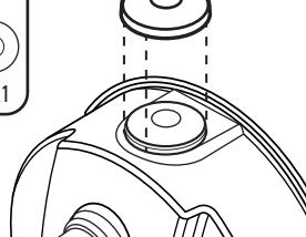
**3** Alignez les trous centraux du luminaire et la sangle de montage (attache à la boîte de jonction). Insérez la longue vis à métaux (CC) dans le trou central du luminaire et enfoncez-la dans la sangle. Remettez le coffret électrique sous tension et assurez-vous que l'éclairage fonctionne correctement.
