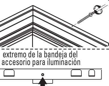
8 Habrá un agujero pretaladrado en el extremo del armazón (en el extremo opuesto del soporte de montaje). Inserte el tornillo para metales largo (G) a través del agujero ubicado en el armazón y apriételo en el agujero roscado ubicado en la bandeja del accesorio para iluminación. Conecte la electricidad en la caja de fusibles o de cortacircuitos.
