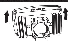
Las cabezas de luz deben estar orientadas con las palabras "THIS SIDE UP" (ESTE LADO HACIA ARRIBA) orientadas hacia arriba.
