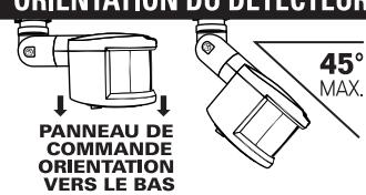
La tête du détecteur (PIR) doit être orientée spécifiquement de façon à empêcher la pénétration d'eau.
