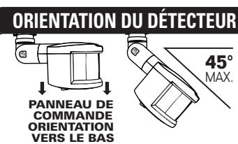
La tête du détecteur (PIR) doit être orientée spécifiquement de façon à empêcher la pénétration d'eau.
