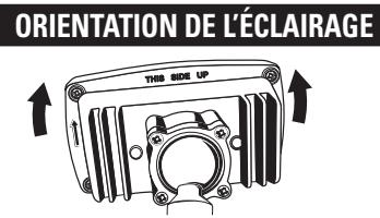
Les têtes d'éclairage doivent être orientées de telle manière que les mots « THIS SIDE UP » (Ce côté vers le haut) soient vers le haut.
