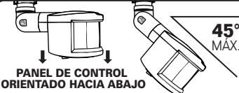
La cabeza del sensor (PIR) debe estar orientada específicamente para impedir que entre agua.
