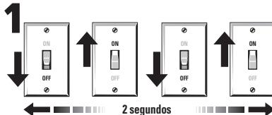
EL SOBRECONTROL MANUAL permite que la luz se encienda en cualquier momento, anulando todos los controles del sensor, para que la luz se encienda independientemente de la hora del día.
