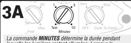
La commande **MINUTES** détermine la durée pendant laquelle les lumières restent allumées. Lorsque la commande **MINUTES** est réglée entre 1 et 10, la lumière ne s'allume que pendant les heures de la nuit.
