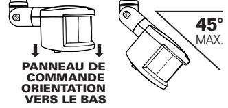
La tête du détecteur (PIR) doit être orientée spécifiquement de façon à empêcher la pénétration d'eau.
