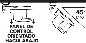
La cabeza del sensor (PIR) debe estar orientada específicamente para impedir la entrada de agua. **El panel de control (ubicado en el lado inferior del sensor) DEBE** estar orientado hacia abajo, hacia el piso, en todo momento para impedir que entre agua y dañe la unidad.
