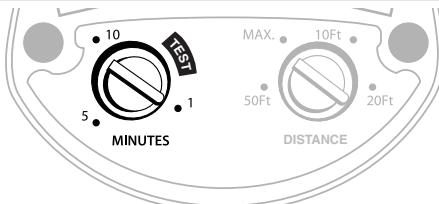
La commande **MINUTES** détermine la durée pendant laquelle les lumières restent allumées. Lorsque la commande **MINUTES** est réglée entre 1 et 10, la lumière ne s'allume que pendant les heures de la nuit.
