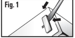
Con un destornillador u otra herramienta similar, retire la tapa del tomacorriente de plástico que cubre el tomacorriente de entrada para insertar el cable de conexión (**Fig. 1**).
