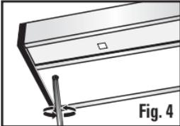
**Fig. 4** Une fois le luminaire fixé à l'armoire, remettez en place le couvercle du compartiment des fils (**fig. 4**). Branchez le cordon d'alimentation pour terminer l'installation.
