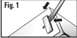
Con un destornillador u otra herramienta similar, retire la tapa del tomacorriente de plástico que cubre el tomacorriente de entrada para insertar el cable de alimentación (**Fig. 1**).
