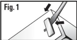
**Fig. 1** À l'aide d'un tournevis ou d'un outil similaire, retirez le capuchon en plastique qui recouvre la prise afin d'y insérer le cordon de raccordement (**fig. 1**).
