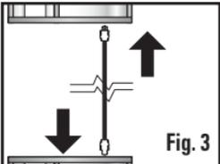
**Fig. 3** Si vous comptez installer un deuxième ou un troisième luminaire, raccordez-le simplement à un luminaire préalablement installé, en suivant les instructions décrites aux étapes 1 à 4. Assurez-vous que l'alimentation est coupée avant de raccorder des luminaires supplémentaires. Assurez-vous également que la distance entre les luminaires n'excède pas la longueur du cordon de raccordement (**fig. 3**).
