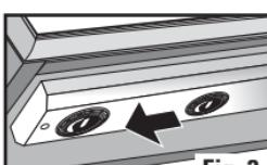
**4** Une fois que la barre d'éclairage sera à sa place, acheminez votre cordon d'alimentation électrique jusqu'à la prise de courant la plus proche. Votre barre de lumière halogène est munie d'un interrupteur à bascule à trois positions sur la face du luminaire. La position centrale est la position « OFF » (Arrêt). Les deux autres positions vous permettent de régler l'éclairage sur haut (« HIGH ») ou bas (« LOW ») en fonction de vos besoins (**Fig. 4**).
