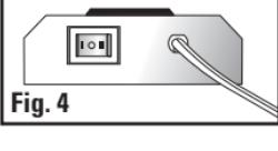
Una vez que la barra de luces esté colocada en su sitio, tienda el cable de alimentación hasta el tomacorriente más cercano. Esta barra de luces xenón tiene un interruptor oscilante de tres posiciones en el frente de la unidad. La posición central es la posición de **APAGADO**. Las otras dos posiciones le ofrecen un ajuste de nivel de luz **ALTO** o **BAJO**, dependiendo de sus necesidades (Fig. 4).
